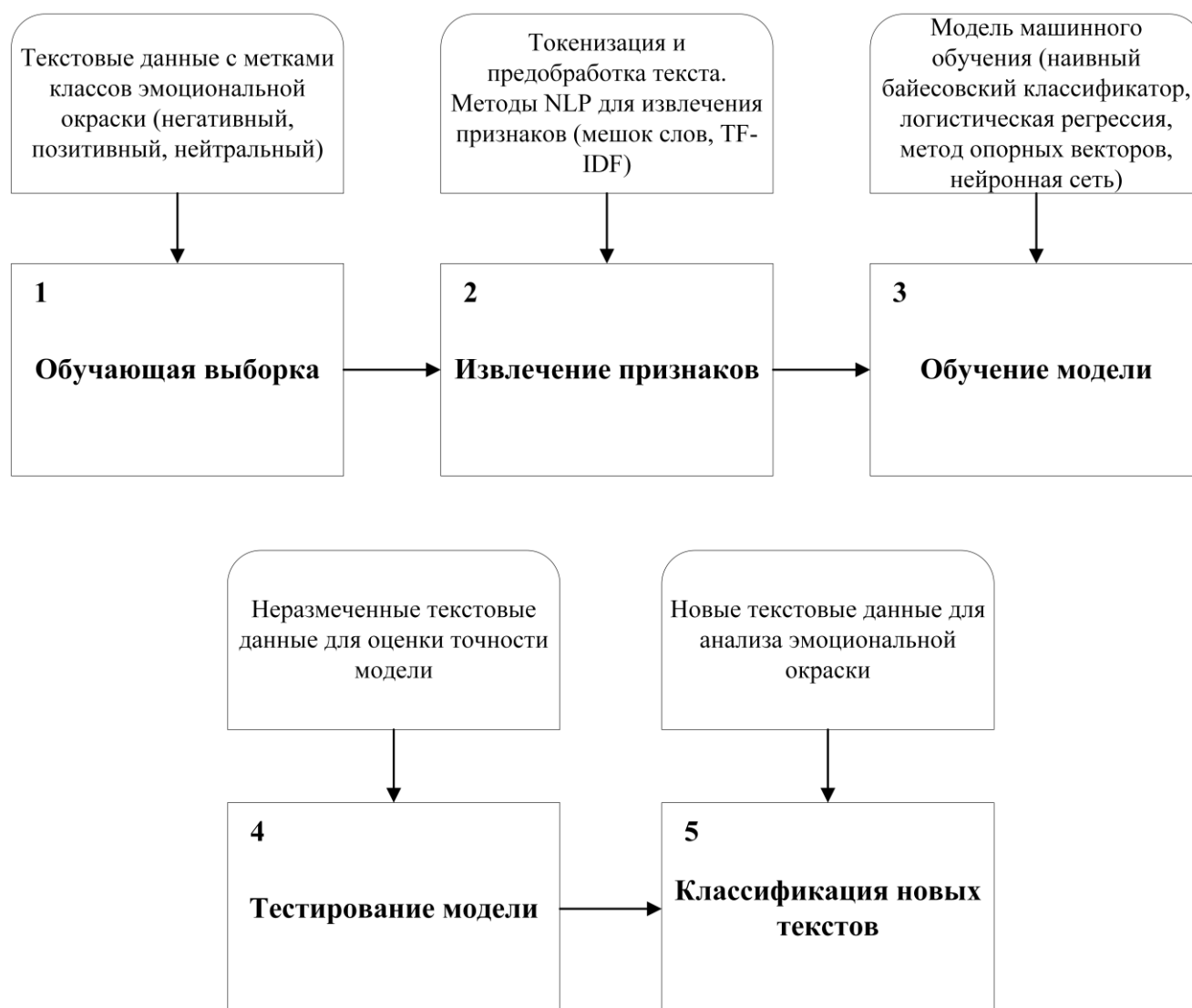
Рис. 4. Структурная схема алгоритма анализа эмоционального окраса текста
