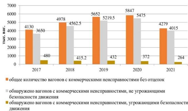
Рис. 3. Динамика вагонов с коммерческими неисправностями, не требующих отцепок для устранения, на сети железных дорог
