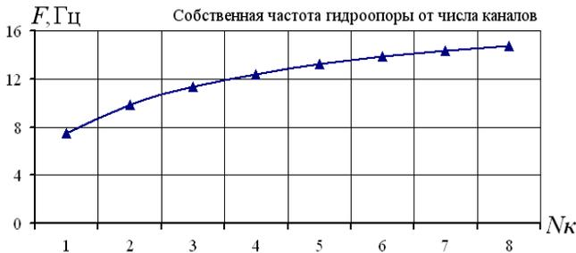
Рис. 8. Зависимость ожидаемых собственных частот МР-гидроопоры от числа ВЭ, создающих внешнее магнитное поле в дроссельных каналах МРТ при  $20^{\circ}C$
