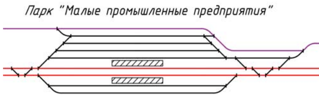
Рис. 4. Схема путевого развития парка «Малые промышленные предприятия»
