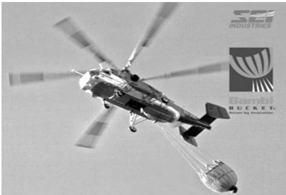
Рис. 3. Вертолетное водосливное устройство «Bambi Bucket»
