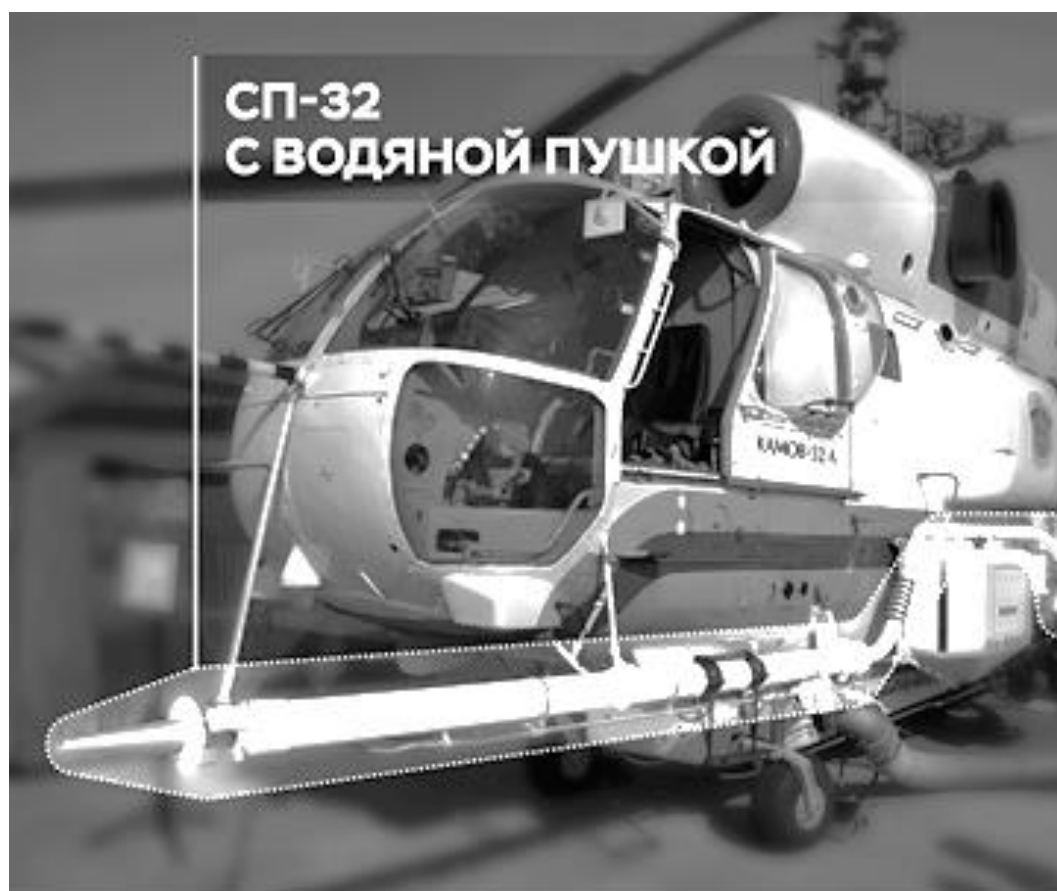
Рис. 6. Система пожаротушения СП-32 с водяной пушкой
