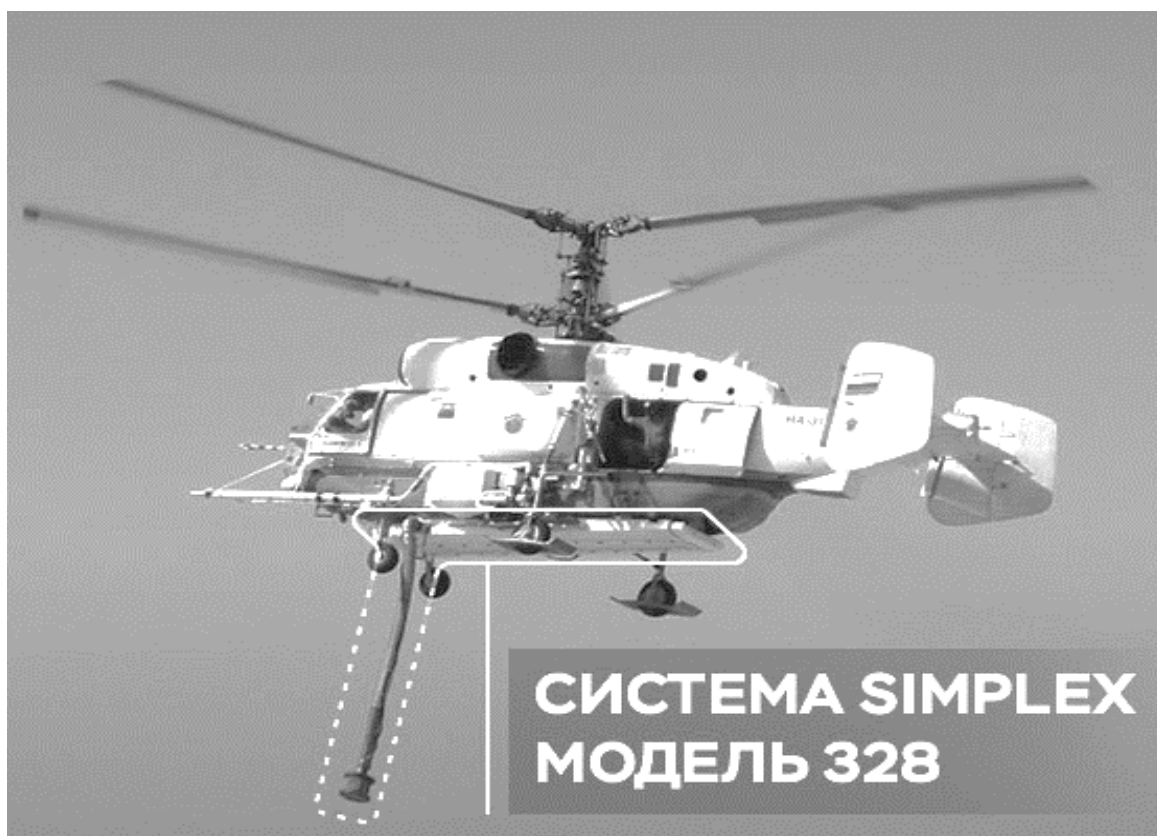
Рис. 4. Система пожаротушения «Simplex»
