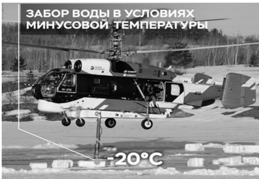
Рис. 5. Система пожаротушения СП-32
