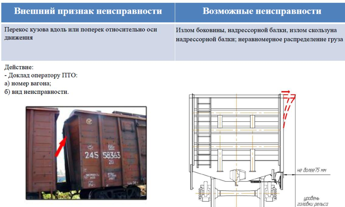
Рис. 3. Обнаружение неисправности «перекас кузова вдоль или поперек движения»
