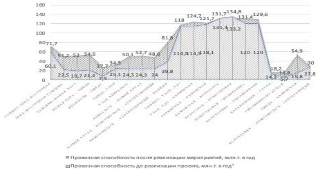
Рис. 4. Результаты расчетов провозной способности до и после реализации предложенных мероприятий, млн.т. в год
