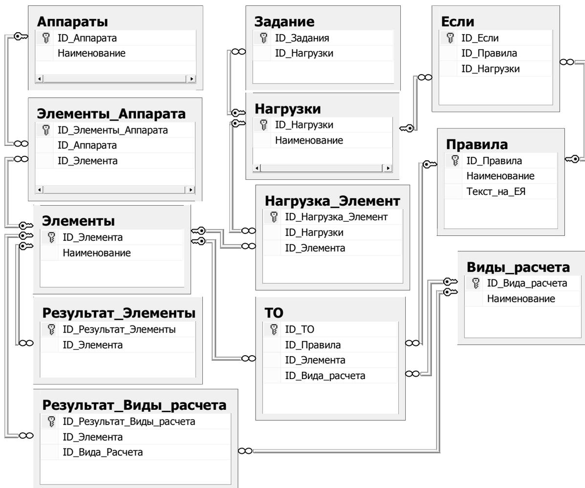
Рис. 8. Схема базы данных для определения элементов технологического оборудования, подлежащих расчету на прочность, и видов расчетов, которые надо выполнять в зависимости от условий эксплуатации.
