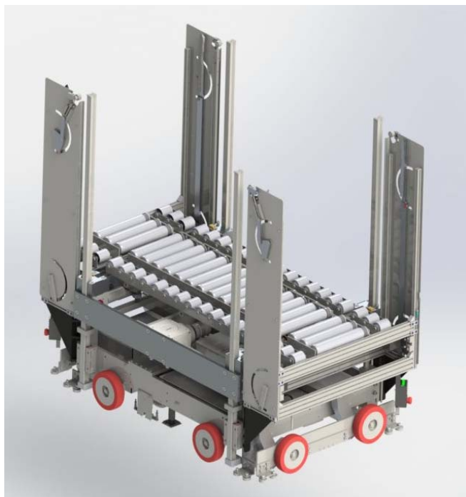
Рис. 2. RoverLog, оборудованный роликовым конвейером
