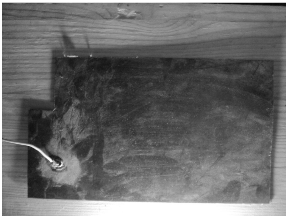
Рис. 3. Медная пластина для контакта со ступнями ног (30х 50 сантиметров)
