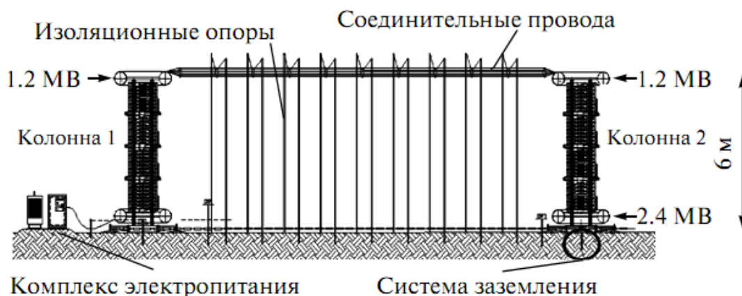
Рис. 5. Схема комплекса МИК ГИН при полевых испытаниях
