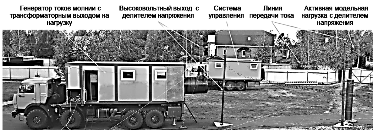
Рис. 4. Испытаний МИК ВМГ на предельную нагрузку сопротивлением 10 Ом
