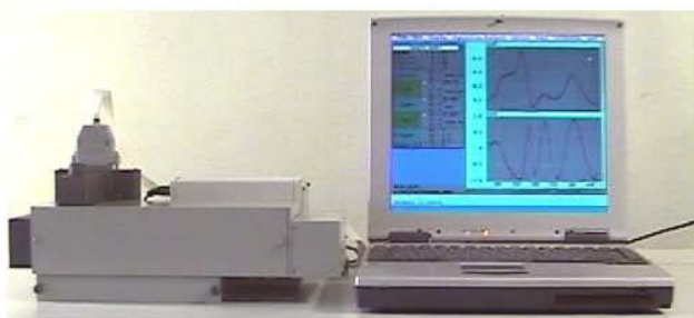
Рис. 3. Информационно-моделирующая система МФАИМС-128, основанная на 128-канальном спектроэллисометре и ориентированная на диагностику жидкостей при взятии их образцов [1].
