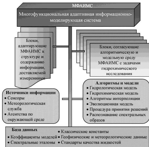
Рис. 1. Концептуальная структурная схема многофункциональной адаптивной информационно-моделирующей системы для гидрофизических исследований (МФАИМС), ориентированная на оценку физико-химических характеристик водных объектов и других жидкостей.
