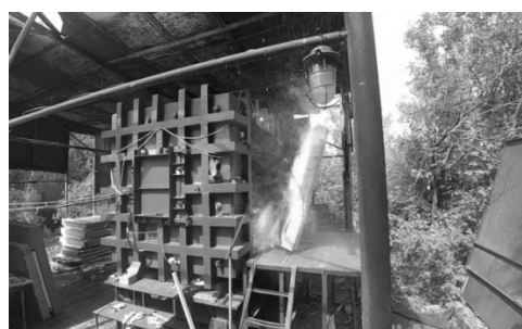
Рис. 6. Догорание смеси внутри камеры (417 мс)
