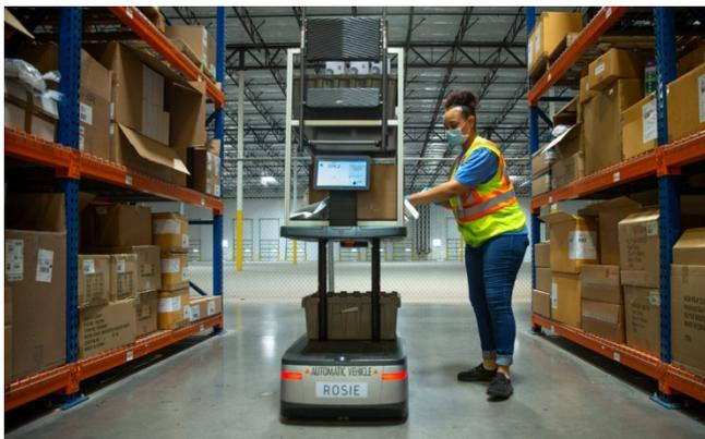
Рис. 2. Коллаборативный робот (кобот) на складе
