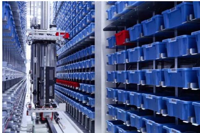
Рис. 1. Общий вид межстеллажного проезда с краном-штабелером.
