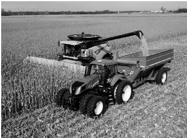
Рис. 2. Колесный трактор с универсальной, оснащенной трекером, прицепной тележкой
