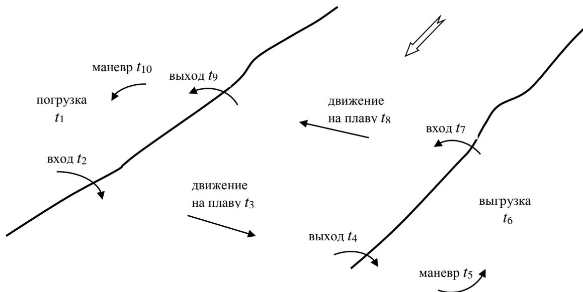
Рис. 1. Расчетная схема для определения продолжительности рейса переправочно-десантного средства
