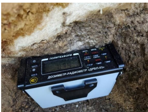
Рис. 3. Прибор для измерения МЭД расположен в шурфе (точка 1,59°41'48.4"N, 30°10'42"E) в районе обнажения диктионемовых сланцев на г. Кирхгоф, лето 2020 года. Фото В.А. Туманова
