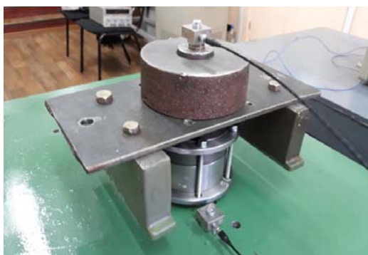
Рис.7. Экспериментальная установка для испытаний гидропоры ОМГ-50 на вибростенде с датчиками входного и выходного сигналов
