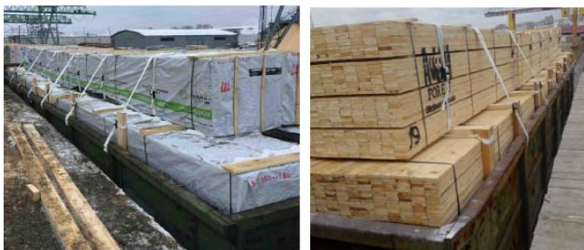
Рис. 2. Способ № 1 размещения и крепления пакетированного пиломатериала в полувагоне
