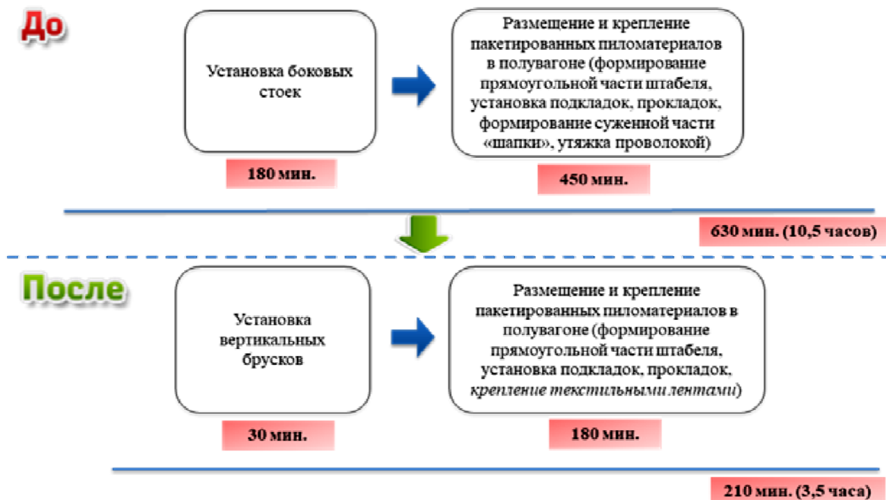
Рис. 7. Картирование процессов размещения и крепления пакетированного пиломатериала в полувагоне с использованием реквизита крепления из проволоки (состояние «до») и текстильных лент (состояние «после»)
