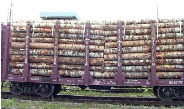
Рис. 6. Способ № 4 размещения и крепления круглого лесоматериала в специализированной платформе
