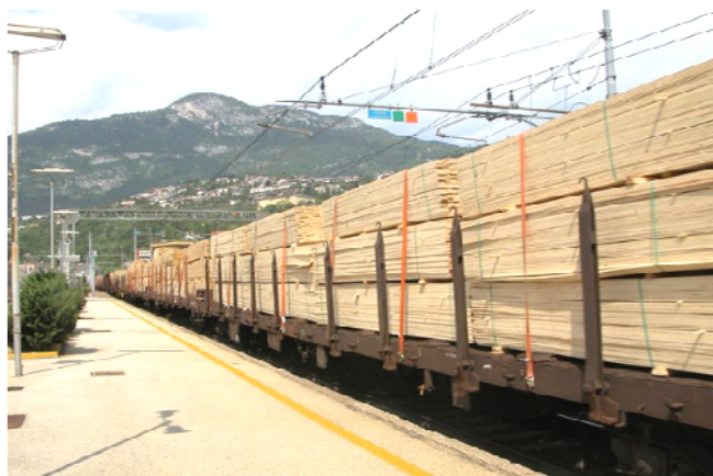
Рис. 1. Способ перевозки пиломатериала на ж.-д. вагонеплатформе при перевозках в Австрии
