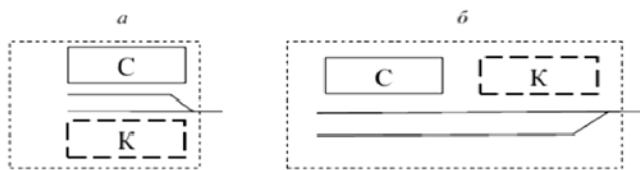
Рис. 2. Схемы планировок контейнерных терминалов: тупиковая поперечная (а) и тупиковая продольная (б)
