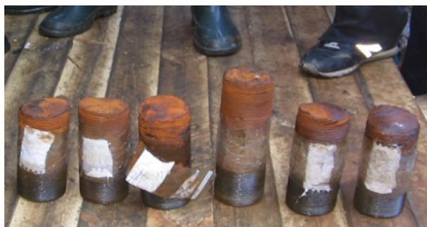
Рис. 2. Разрушенные шпильки
