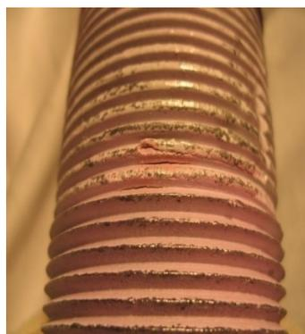
Рис. 3. Шпилька с усталостными трещинами и коррозионными повреждениями
