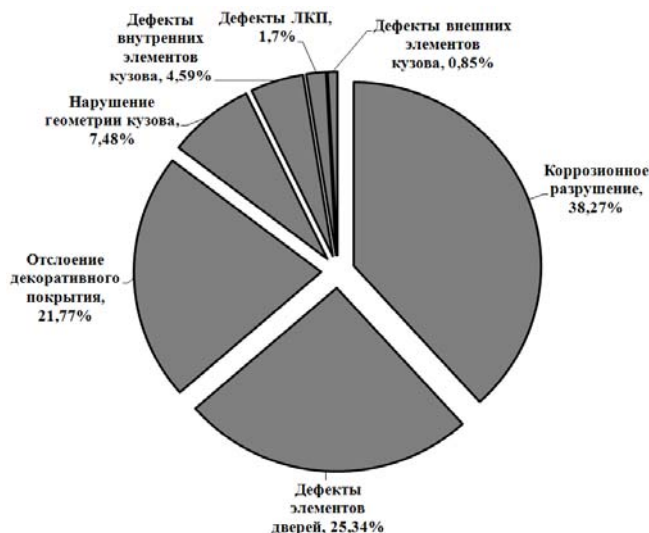
Рис. 1. Характерные неисправности кузова автомобилей ВАЗ-2105, ВАЗ-2107 и их процентное соотношение
