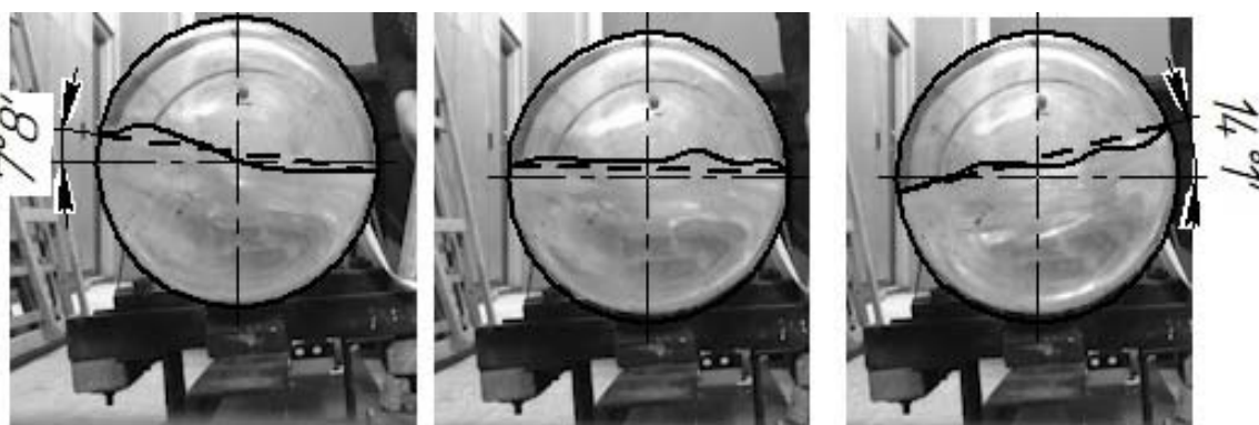
Рис.10. Свободная поверхность жидкости при боковой качке
