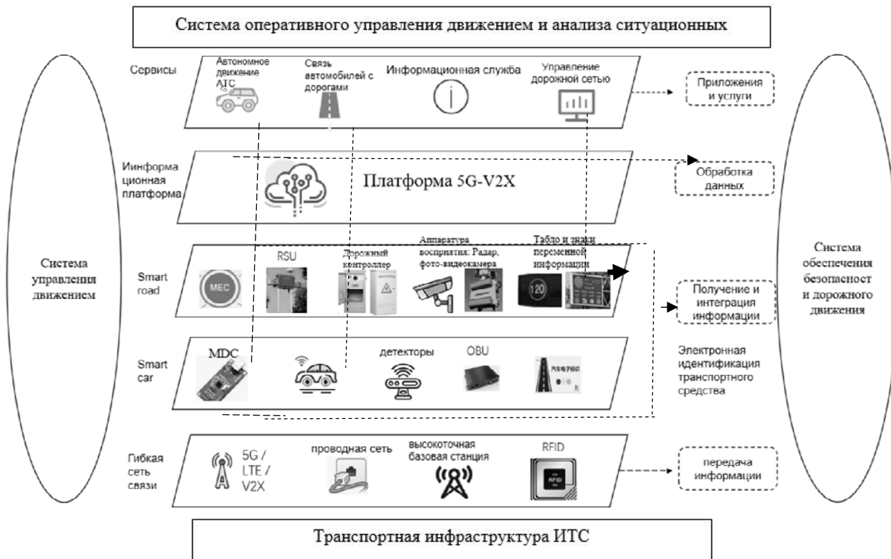
Рис. 1. Схема построения системы Smart Highway 5G-V2X
