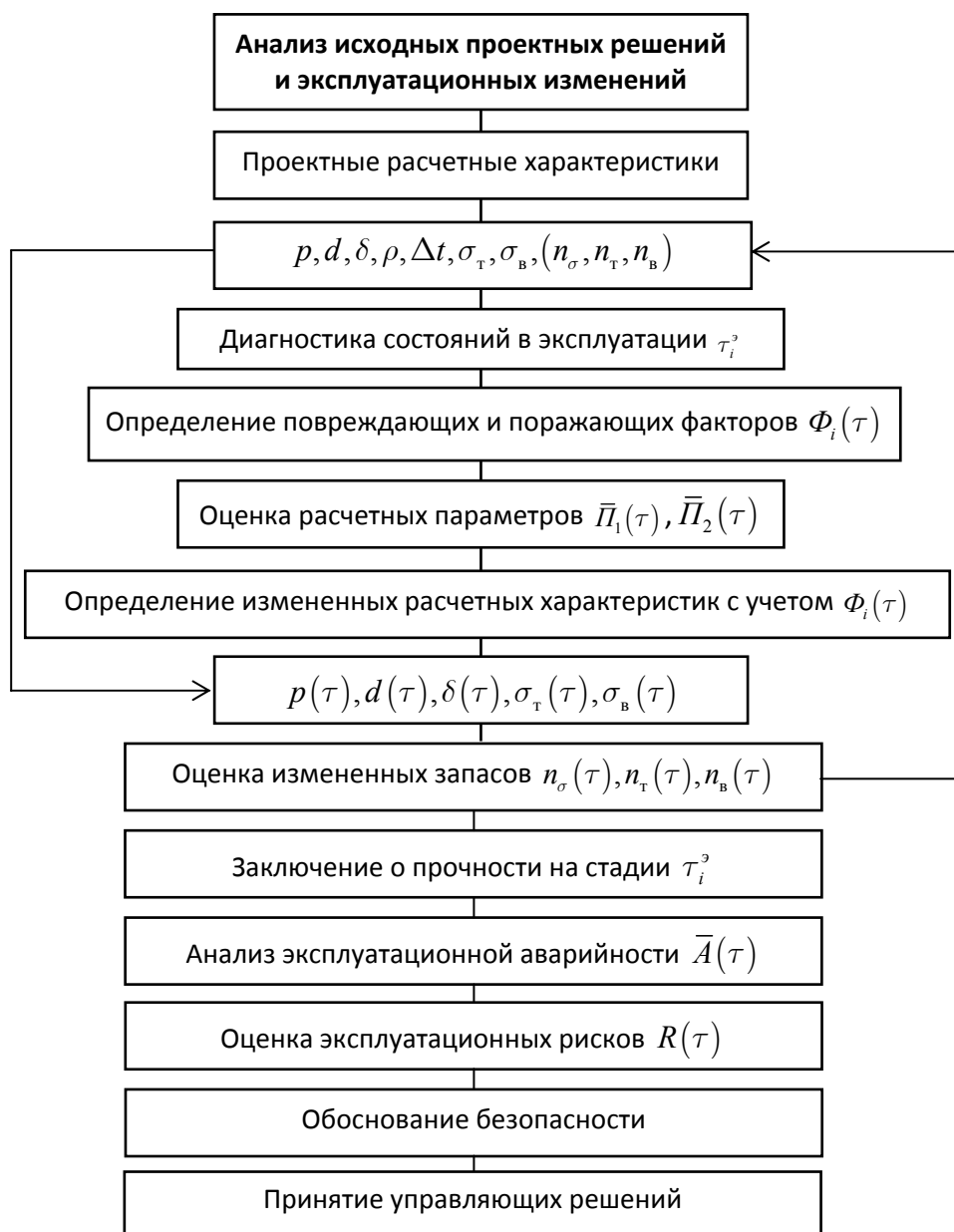
Рис. 2. Принципиальная схема анализа прочности по проекту и обоснования эксплуатационной прочности и безопасности по критериям рисков
