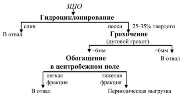
Рис. 3. Технологическая схема извлечения золота из ЗПО
