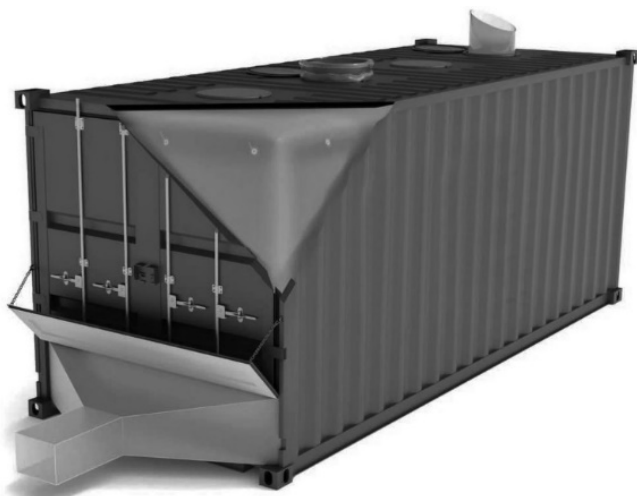
Рис. 1. Специализированный контейнер для перевозок сыпучих грузов, оборудованный полипропиленовым вкладышем [5]
