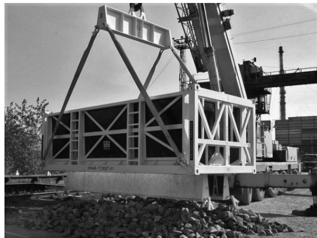
Рис.2. Пример полной разгрузки КОТТА-контейнера [9]
