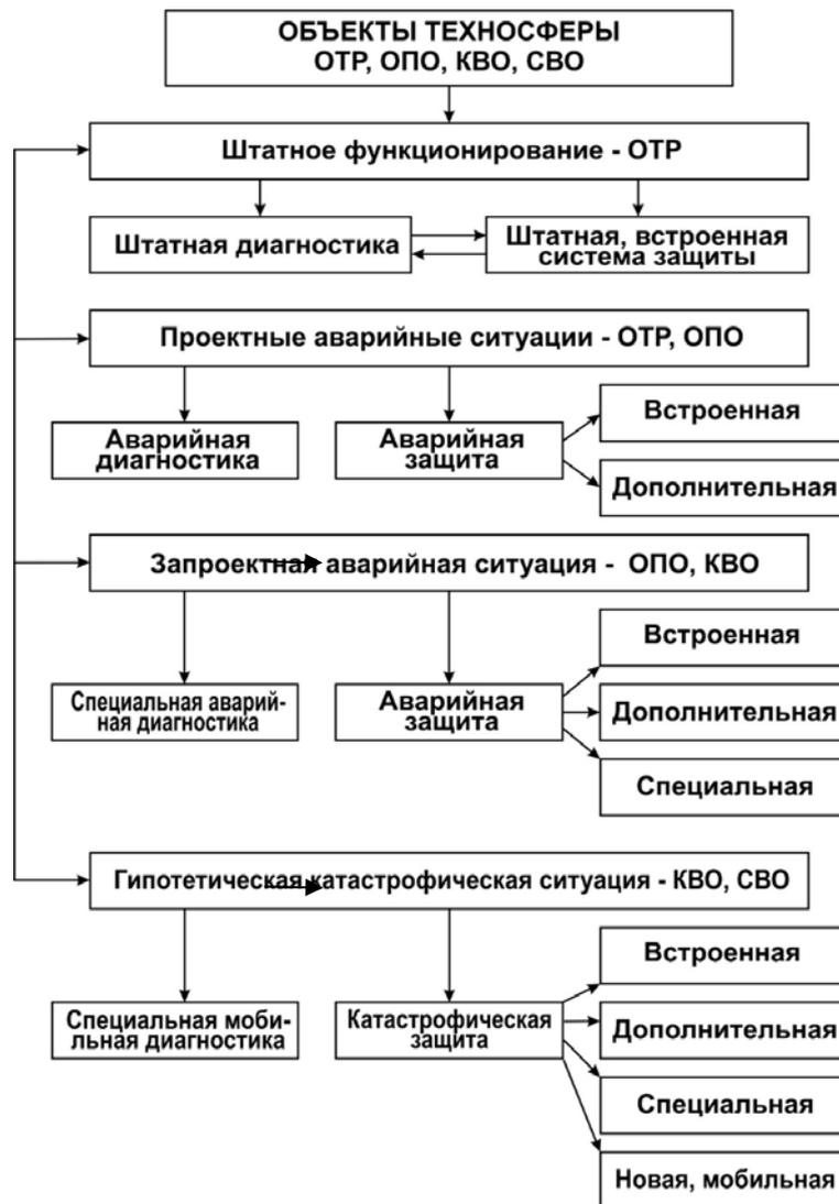
Рис. 4. Структурная схема объектов, опасных ситуаций, диагностики и защиты
