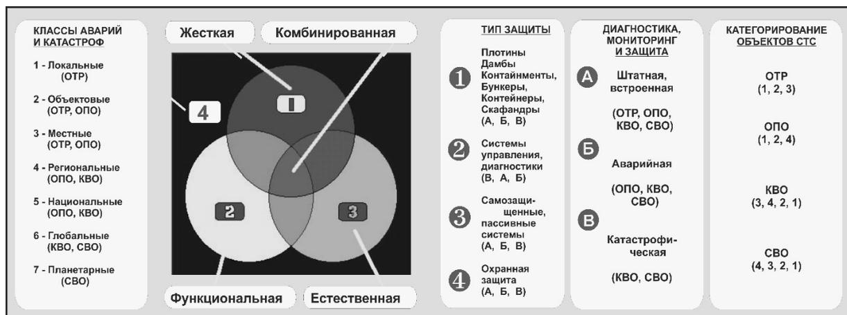
Рис. 1. Структура систем защиты объектов техносферы от чрезвычайных ситуаций
