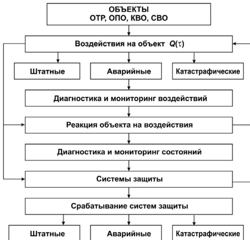
Рис. 5. Взаимодействие системы диагностики и защиты объектов в штатных и нештатных ситуациях
