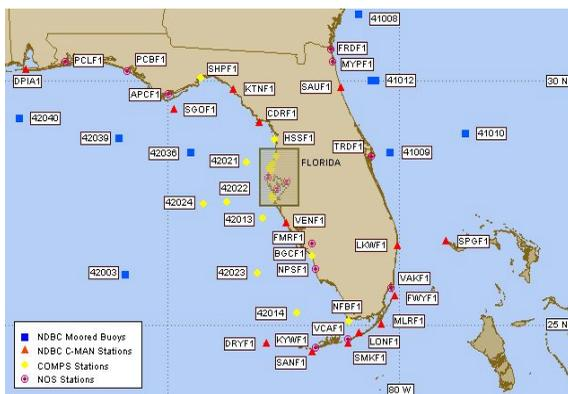
Существующие наблюдательные средства охватывают акватории Мексиканского залива и экваториального пояса Мирового океана (рис. 1, 2) и оборудованы частой сетью буйковых и метеорологических станций, проводящих регулярные измерения температуры поверхности океана, температуры и давления приземного воздуха, скорости ветра приземного ветра.
