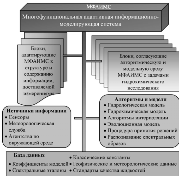
Рис. 2. Концептуальная структурная схема многофункциональной адаптивной информационно-моделирующей системы для гидрофизических исследований (МФАИМС), ориентированная на оценку физико-химических характеристик водных объектов и других жидкостей.
