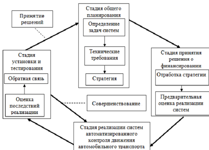
Рис. 1. Жизненный цикл оптимальных характеристик измерительных средств автоматизированного контроля движения автомобильного транспорта
