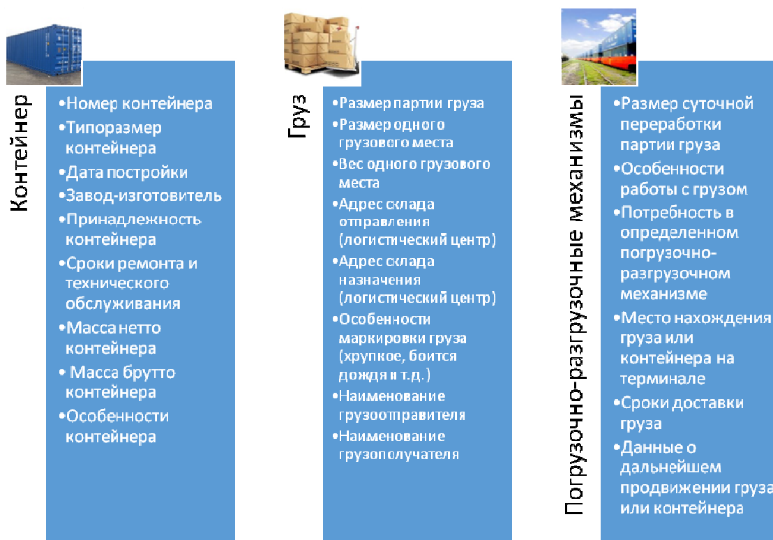
Рис. 2. Основные данные, используемые на контейнерных терминалах единой цифровой платформы
