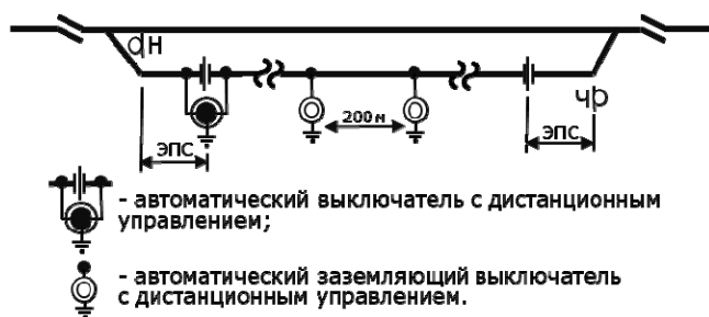
Рис. 1. Концептуальная схема секционирования контактной сети грузового фронта
