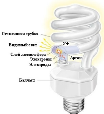
Рис. 2. Устройство типичной компактной люминесцентной лампы (УФ – ультрафиолетовое излучение).
