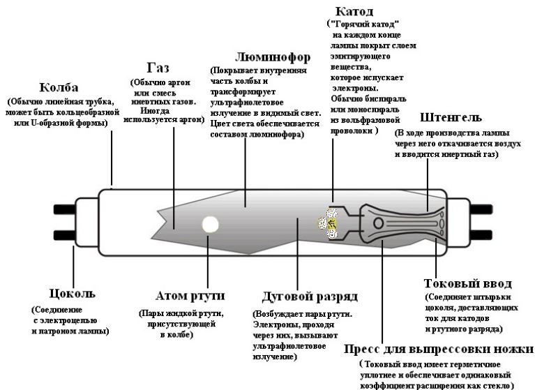
Рис. 1. Устройство типичной люминесцентной лампы.
