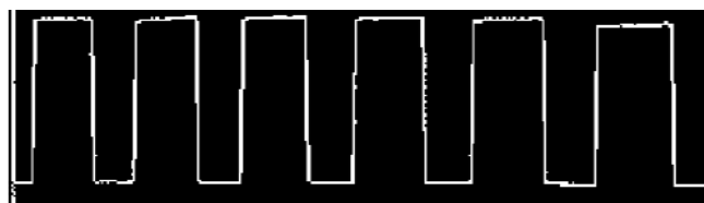
Рис. 4. Форма сигнала с датчика положения коленчатого вала.
