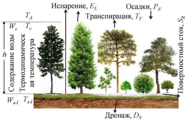
Рис. 3. Принципиальная схема модели водного баланса леса.
