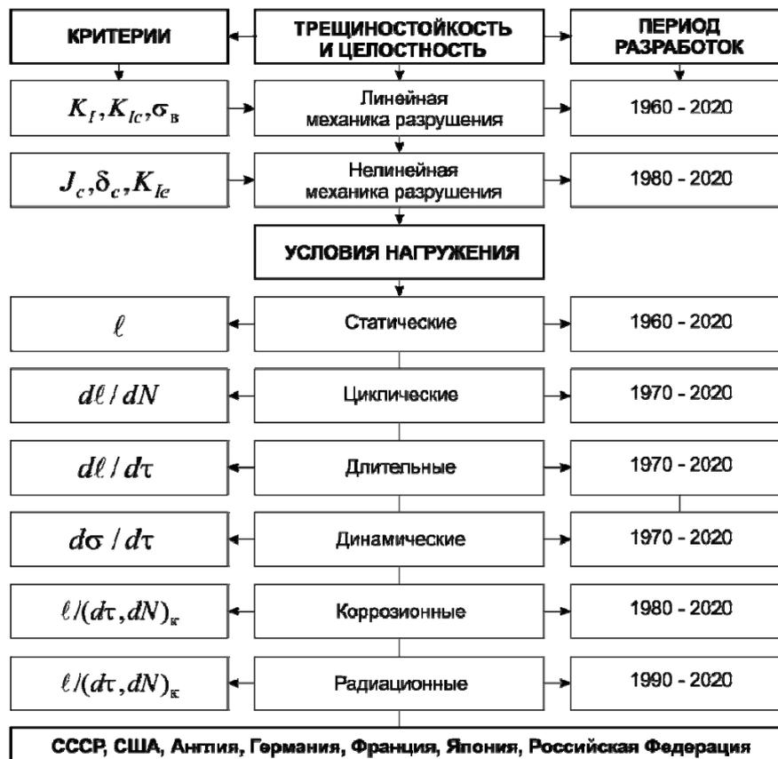
Рис. 2. Направления и этапы исследований трещиностойкости и целостности и их критериальных характеристик
