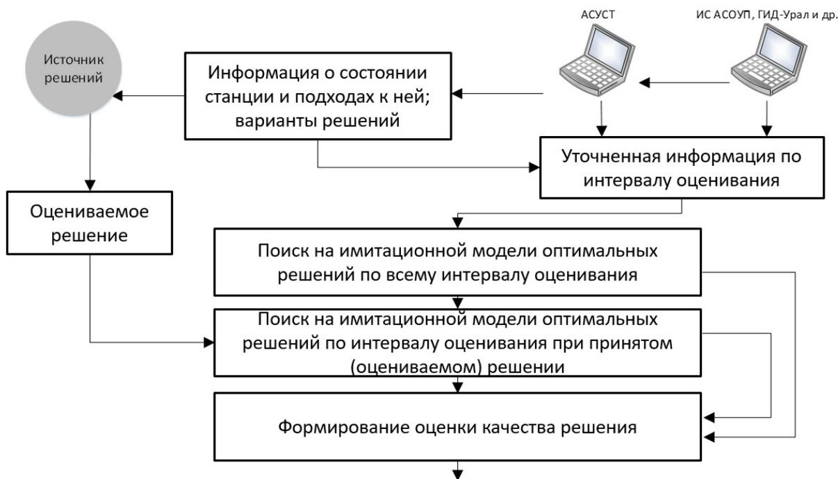
Рис. 1. Технология оценки качества решений при управлении технической станцией
