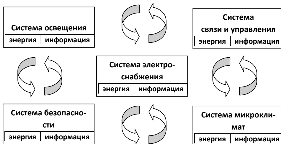
Рис. 1. Структурная схема взаимодействия компонентов полиструктуры умного дома (энергия – энергия, информация – информация, энергия – информация, информация – энергия)
