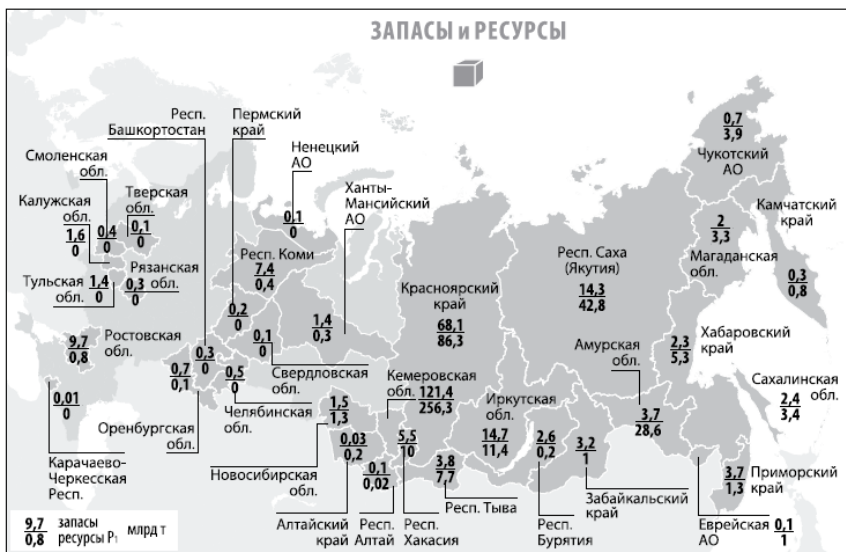
Рисунок 2. Распределение запасов углей и их ресурсов категории P 1 по субъектам Российской Федерации, млрд. т [23].
