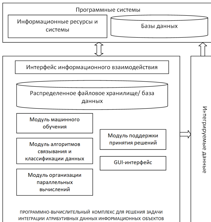
Рис. 1. Схематическое представление структуры программно-вычислительного комплекса для решения задачи интеграции атрибутивных данных информационных объектов
