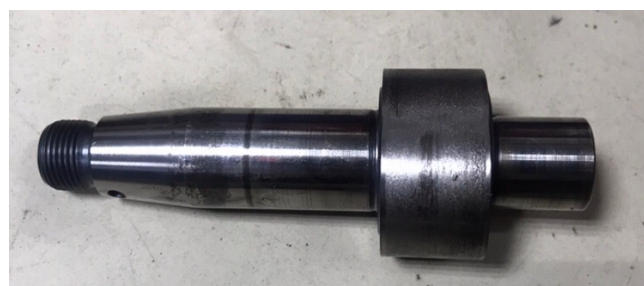
Рис. 4. Механический износ вала ТНВД
