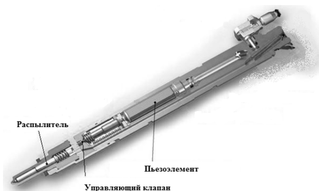
Рис. 2. Структурная схема ЭГФ с пьезоприводом [4]
