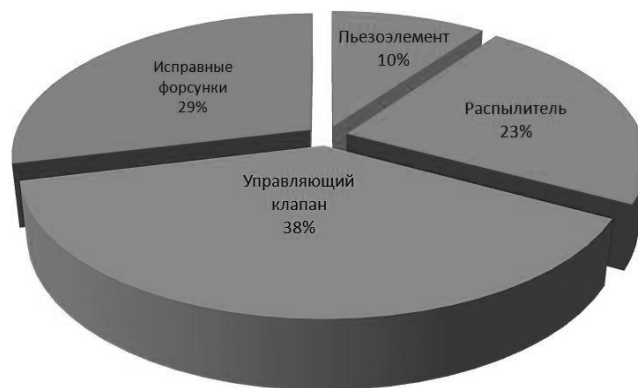
Рис. 7. Диаграмма отношения неисправных элементов ЭГФ с пьезоприводом
