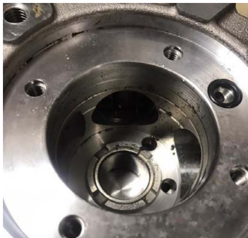
Рис. 5. Абразивный износ (металлическая стружка) в корпусе ТНВД
