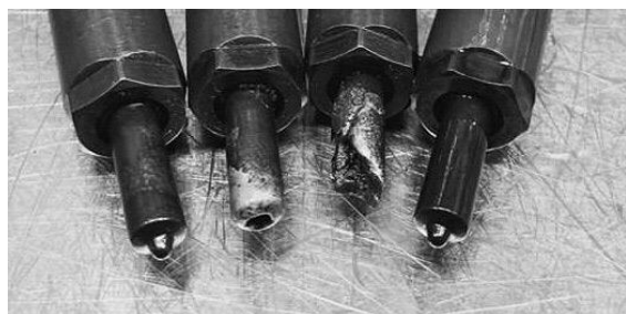
Рис. 6. Поврежденные температурным воздействием распылители электрогидравлических форсунок
