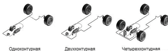
Рис 1. Виды пневматической подвески разных конструктивных вариаций
