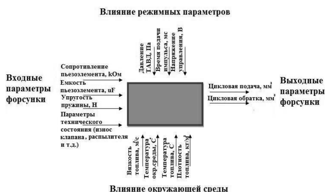
Рис. 1. Структурная схема процесса функционирования ЭГФ с пьезоприводом
