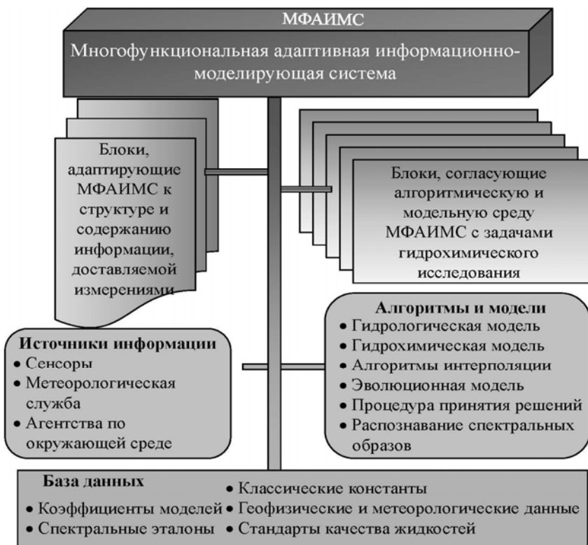
Рис. 7. Концептуальная структурная схема МФАИМС, ориентированная на оценку физико-химических характеристик водных объектов и других жидкостей в реальном времени.
