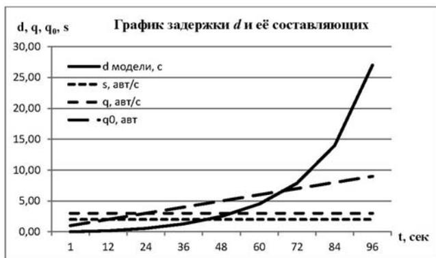
Рис. 4. Зависимость времени задержки ТС от параметров модели
