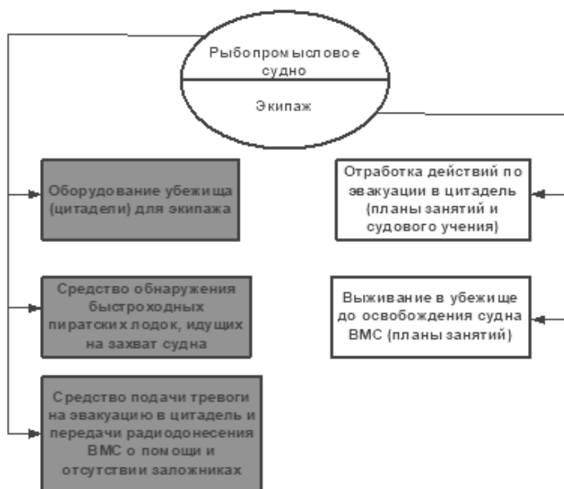
Рис. 1. Концептуальная модель безопасности рыбопромыслового судна на промысле в пиратском районе
