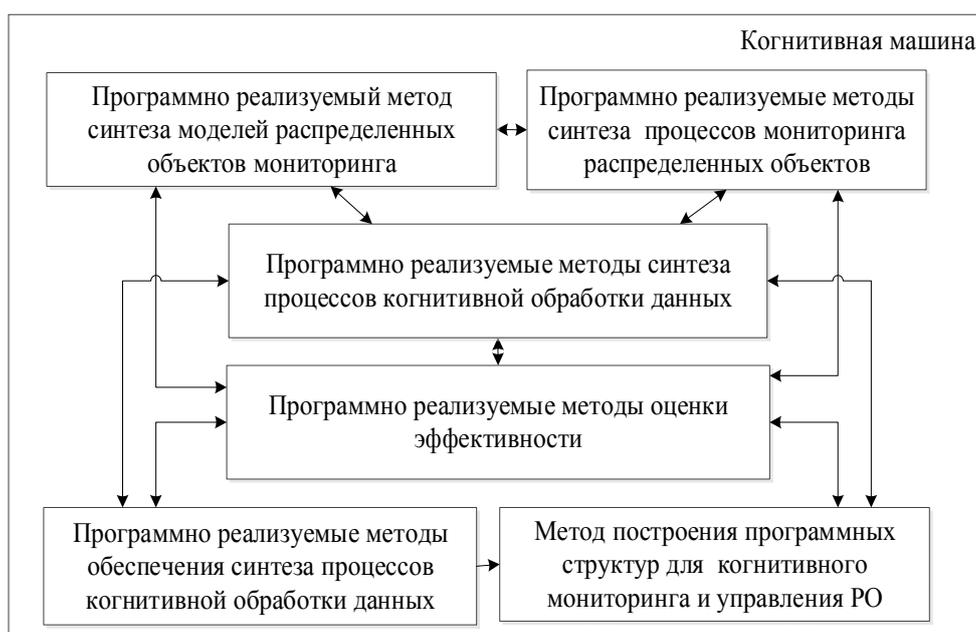
Рис. 4. Система программно-реализуемых моделей и методов когнитивного мониторинга распределенных объектов
