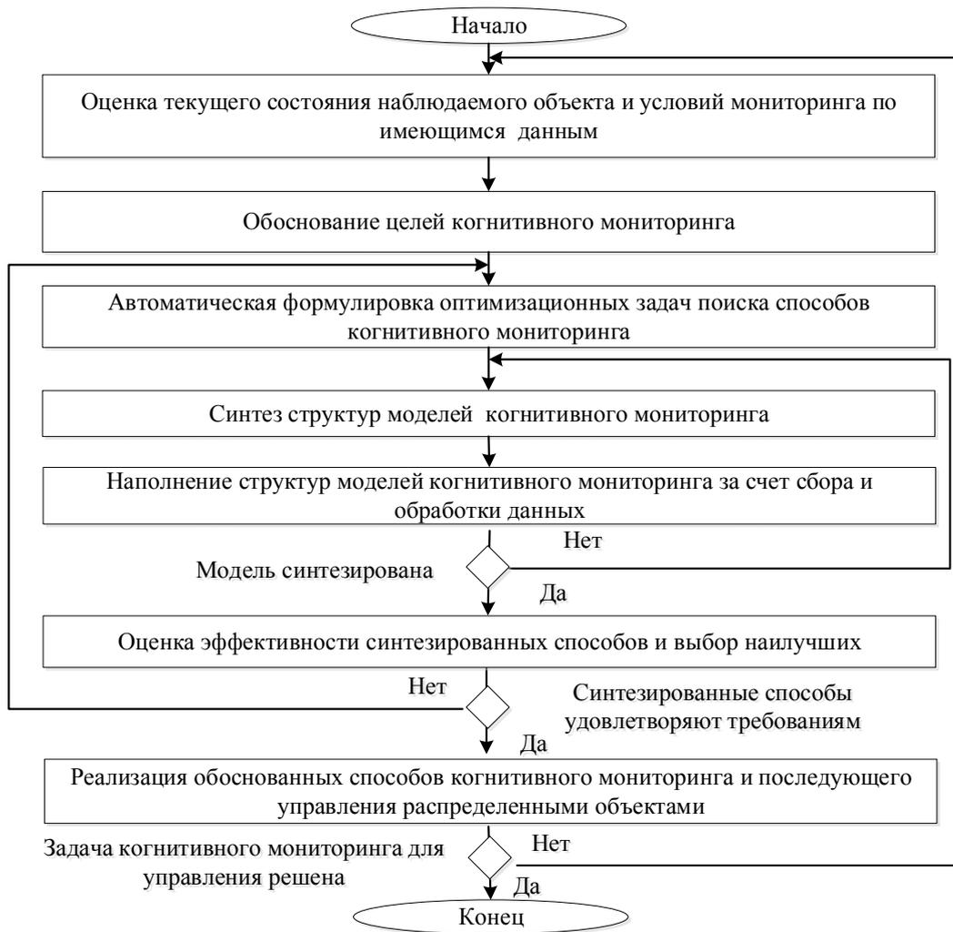
Рис. 3. Обобщенный алгоритм когнитивного мониторинга распределенных объектов
