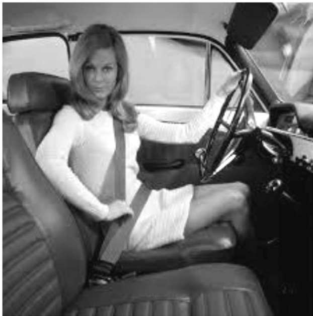
Рис. 2. Правильное использование трехточечного ремня безопасности
