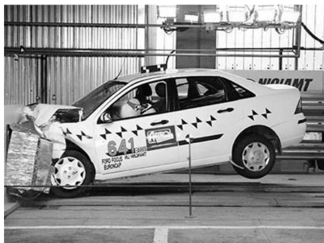
Рис. 1. Испытание легкового автомобиля на фронтальное столкновение
