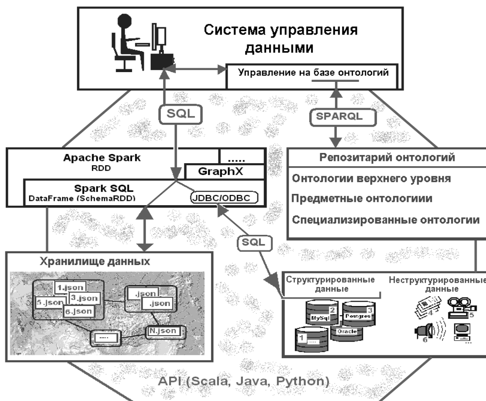
Рис. 1. Схема веб-среды интеграции разнородных и распределенных данных по свойствам веществ
