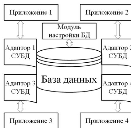
Рис. 2. Структурная схема интеграции цифровых двойников на уровне единой базы данных
