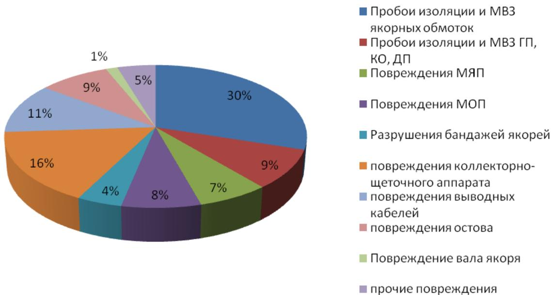
Рис. 10. Распределение отказов по узлам двигателей НБ-418К6 (в процентах) депо Боготол за 2012 – 2014 гг. (после заводского ремонта)
