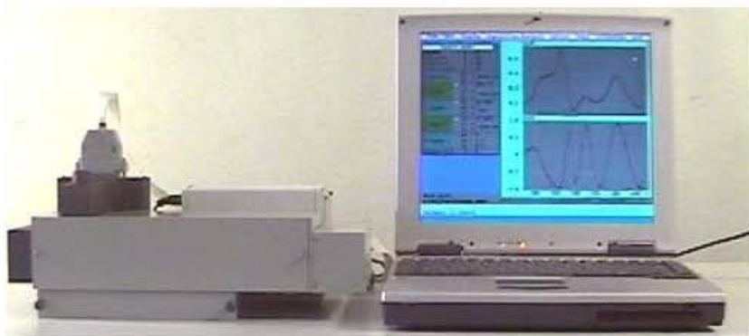
Рис.2. Адаптивный идентификатор - 35-ти каналный спектроэллипсометр для использования в лабораторных условиях или в полевых условиях путем взятия образца жидкости.
