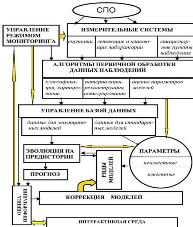
Рис. 2. Схема интерактивной настройки ГМСПО и управления режимом геоинформационного мониторинга.
