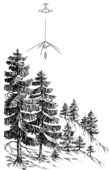
Рис. 7. Установка ретранслятора на крону дерева
